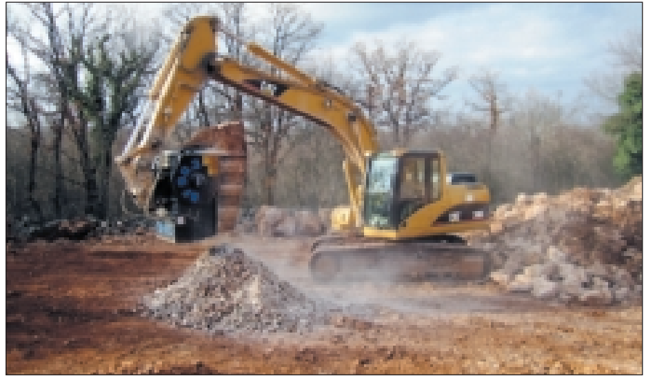
CUCHARA TRITURADORA MB BF 90.3 TRATANDO MATERIAL CALIZO.
